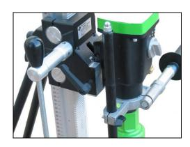
Заблокировать инструмент с помощью винта. Вставить инструмент в стойку. Закрепить инструмент, повернув винт с перекидной рукояткой.
