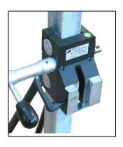
Открыть крепление, поворачивая винт с перекидной рукояткой до тех пор, пока направляющая не будет свободна.
