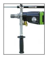
Вставить пружину с кольцом для забора воды и направляющим кольцом в натяжной шкив. Поднять пружину до полного погружения сегментов коронки в кольцо забора воды. Зажать барашковый винт. Выполняя сверление в потолке, открывать подачу воды можно только тогда, когда присоединен отвод воды, отвод воды предварительно нужно прикрепить к стене или потолку.
